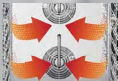
Konwekcja (termoobieg) - idealna, równomierna temperatura w całej komorze
